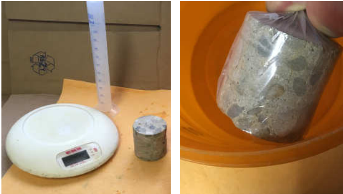
Abbildung 5: Waage, Probekörper und Eimer zur Bestimmung der Wasserverdrängung
