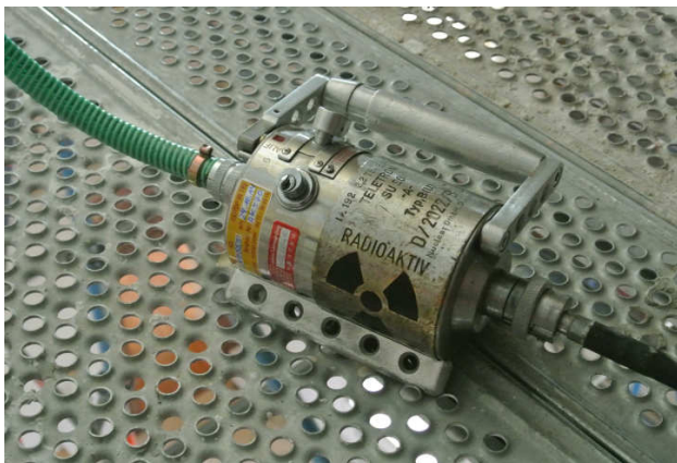
Abbildung 11: links: Strahlenquelle in Sicherheitsbehälter; Abbildung 12: rechts: Sicherheitsbereich
