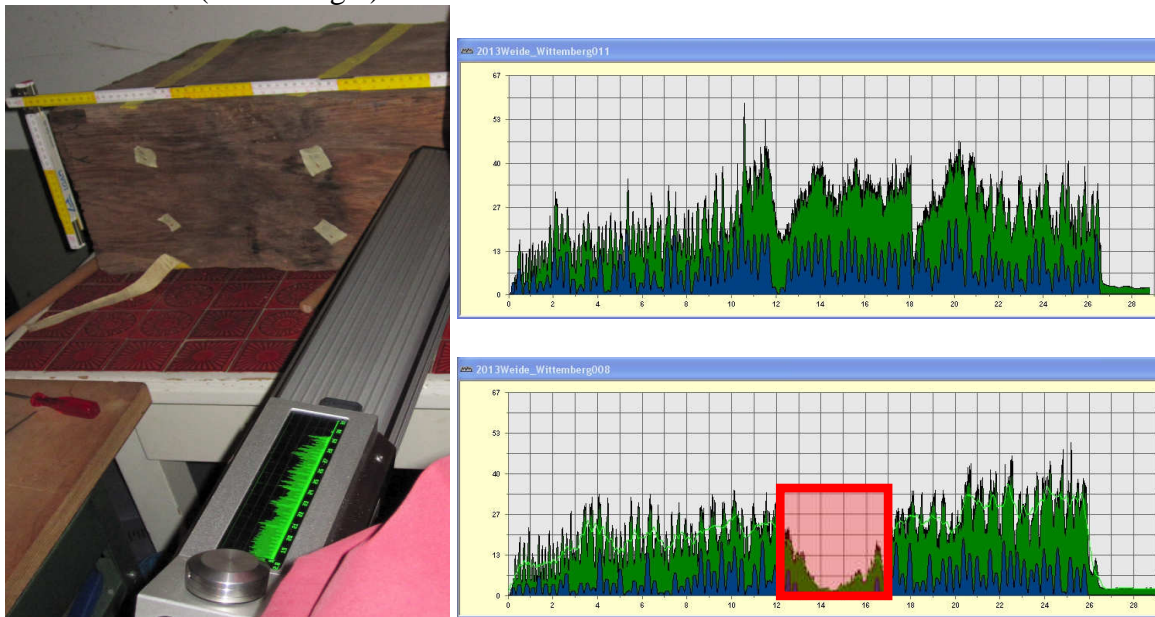
Abbildung 5: links: Bohrwiderstandsmessung an Eichenbalken mit modernem Bohrwiderstandsmessgerät Resi400 von IML wo eine Aufzeichnung des Vorschubes der Bohrnadel und des Bohrwiderstandes möglich ist;
