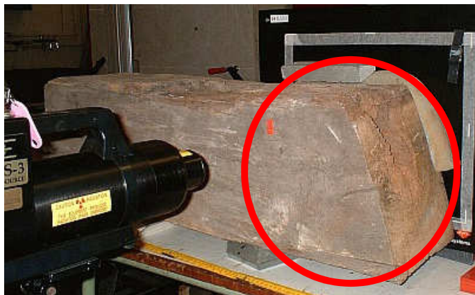
links: Abbildung 1: Marienkirche in Lutherstadt Wittenberg; rechts: Abbildung 2: Eichenbalken an der BAM mit Röntgenblitzröhre (links) und digitalem Matrixdetektor
